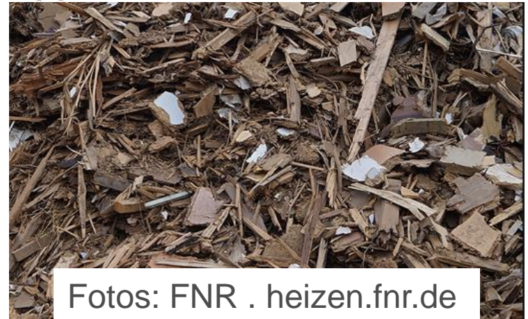
Abb. 11: Hackschnitzel aus Waldrestholz mit Nadeln, Rinde und feinen Ästen. Aschegehalt < 3 Masse-%, Qualität Klasse B, für den emissionsarmen Betrieb von Kleinfeuerungen nicht geeignet.
