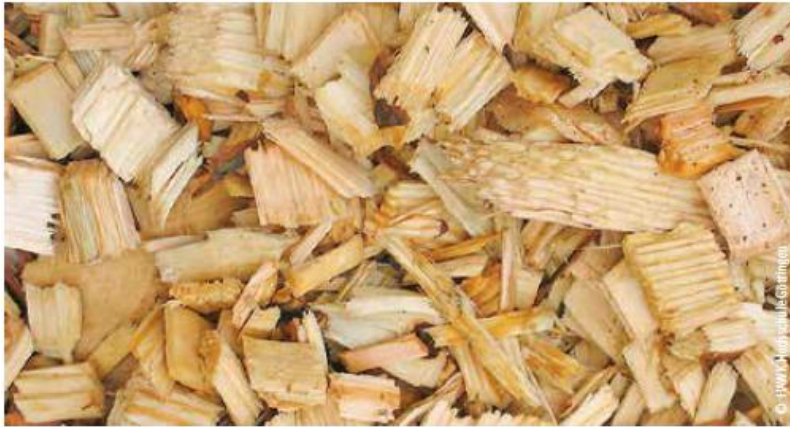
Abb. 7: Hackschnitzel ohne Rinde, Nadeln, Blätter oder feine Äste. Aschegehalt < 1 Masse-%, sehr geringer Feinanteil, Qualität Klasse A1
