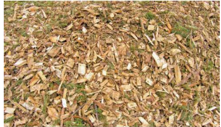
Abb. 11: Hackschnitzel aus Waldrestholz mit Nadeln, Rinde und feinen Ästen. Aschegehalt < 3 Masse-%, Qualität Klasse B, für den emissionsarmen Betrieb von Kleinfeuerungen nicht geeignet.
