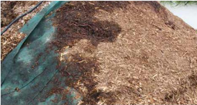
Abb. 15: Deutlich sichtbare Feuchterester und hohe Feinanteile im Hackschnitzelhaufen, für den emissionsarmen Betrieb von Kleinfeuerungen nicht geeignet.
